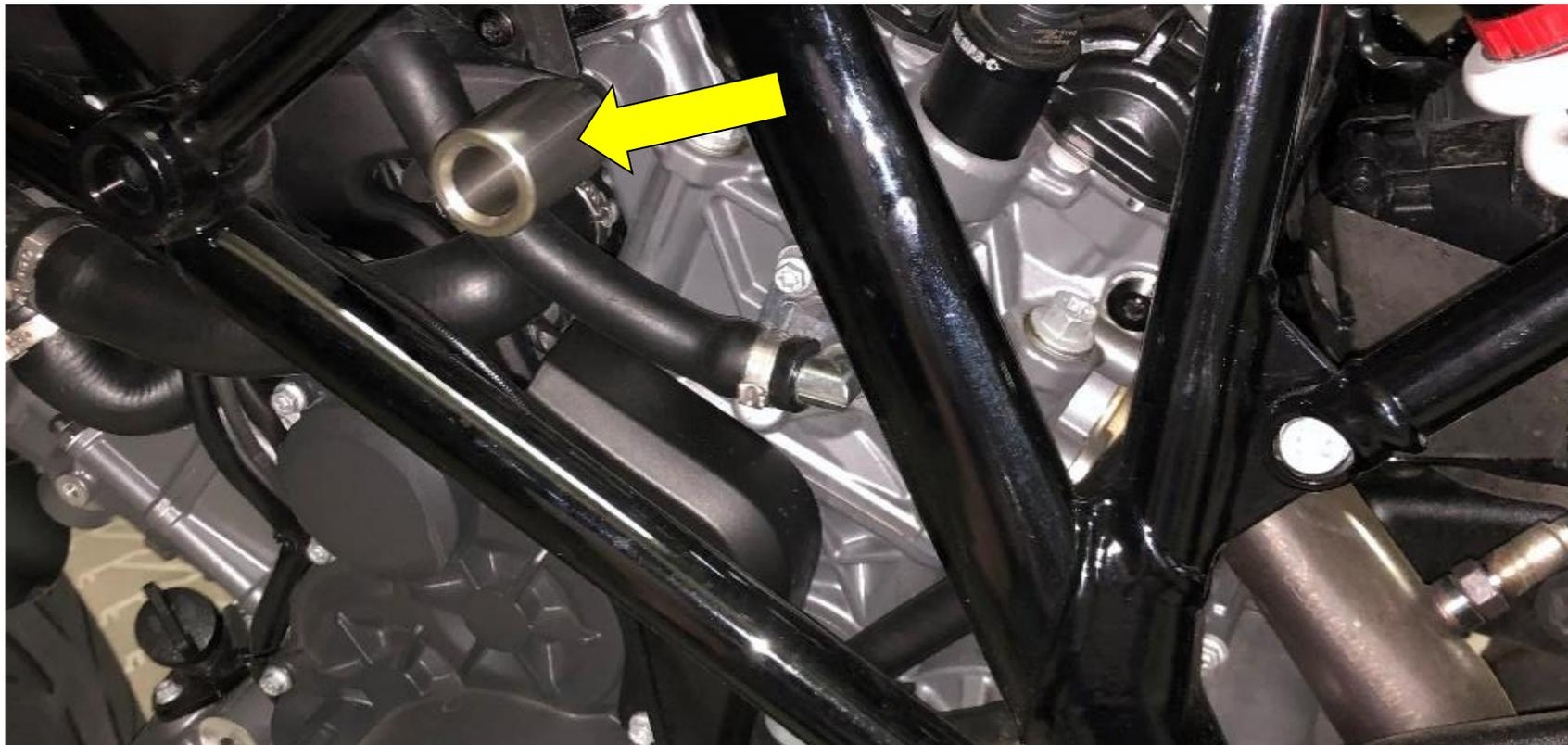
Mit der Schraube **5** die Hülse **2** am Rahmen anschrauben.
