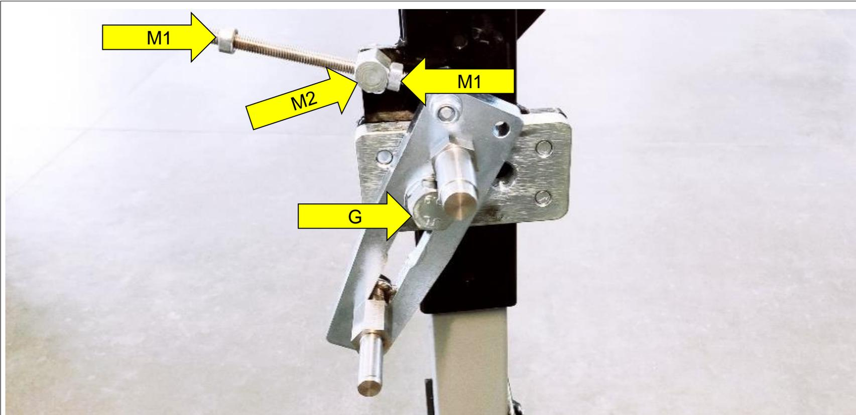
1. Neigungsverstellung an der Adapterplatte montieren. Dazu beide Muttern **M1** sowie die Mutter auf der Rückseite **M2** lösen.
